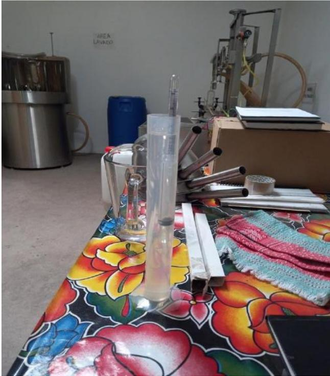
Medición de los grados brix en alcohol, este procedimiento se realizaba en la primera destilación, para conocer los grados que tiene el sishe (líquido de la primera destilación), este debe quedar en 40 a 45 grados. También se realiza este procedimiento para la segunda destilación, que normalmente son de 80-60 grados, pero se ajusta a 50 grados, con las colas del mezcal o en su defecto con agua tridestilada.
