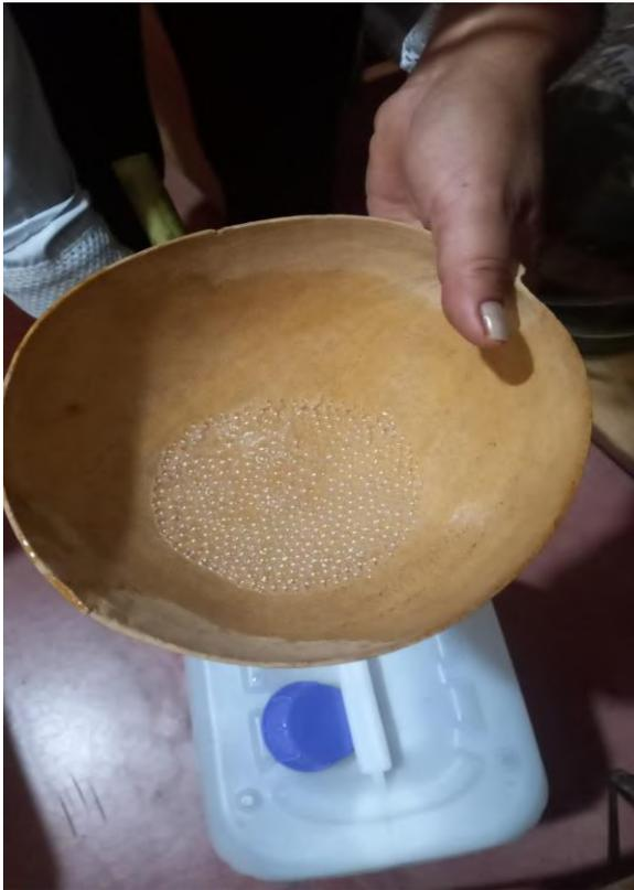
La menencia se sigue utilizando para conocer los grados de alcohol que tiene el mezcal, pero se utiliza el densímetro para comparar y comprobar. En la fotografía se muestra a 50 grados, la burbuja es pequeña y se mantiene por 30 segundos.
