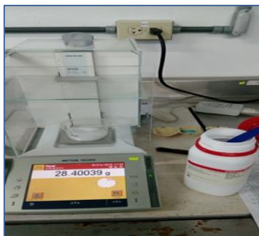
Figura 10. Proceso de pesado de premezcla de minerales y vitaminas en balanza analítica (Mettler Toledo).
